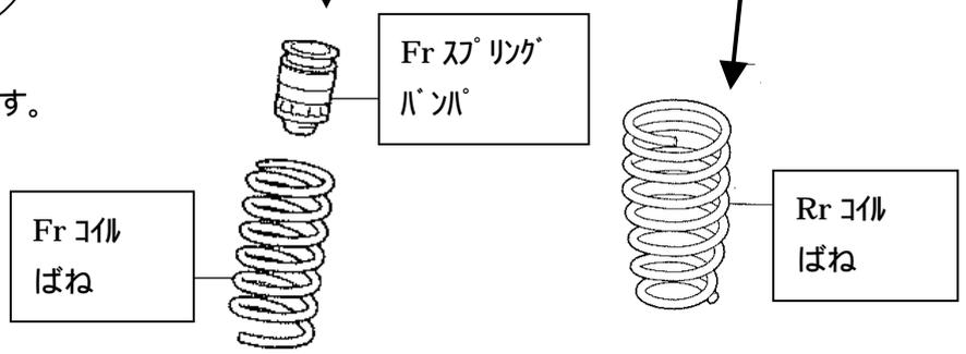
後付け部品として設定したコイルばねを平成18年1月1日以降に製作された車両に取り付けた場合、一部の車両において前部雾灯下縁高さが保安基準に抵触する場合がある。
