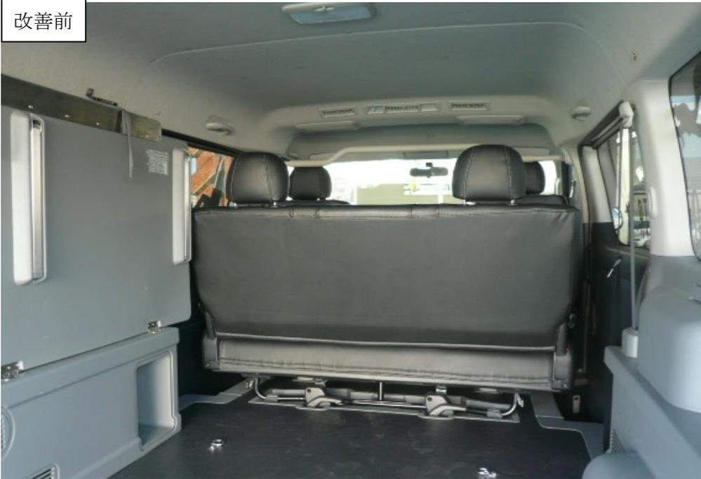
ベッドキット折りたたみ収納時、車両備え付けのセパレーターバー左側キャッチ部分がベッドに隠れ、セパレーターバーの取付が出来ない
