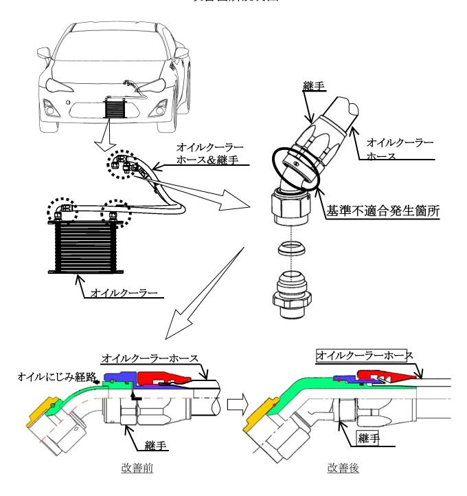
サーキット走行向けにオイルクーラー等を架装した車両において、オイルホースを接続する 継手の構造が不適切なため、オイルのにじみが発生するものがある。そのため、そのままの 状態で使用を続けると、継手よりオイル漏れを起こし、最悪の場合、エンジンが破損する おそれがある。
