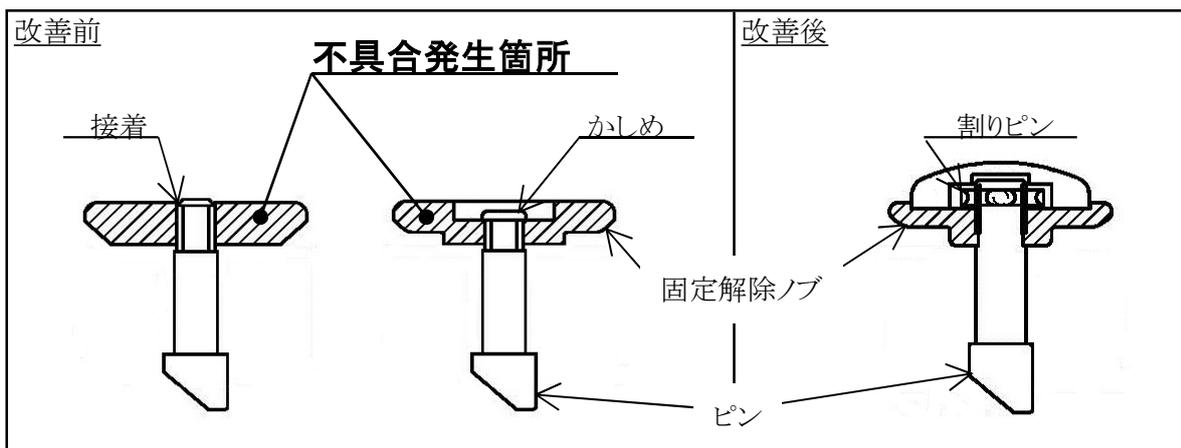
救急車のストレッチャー用ファスナー（架装メーカーオプション）において、固定解除ノブの結合強度が不足しているため、当該ノブが破損することがある。そのため、そのままの状態を使用を続けると、当該ノブが外れ固定解除操作ができず、ストレッチャーのアンダーキャリア（下部搬送）
