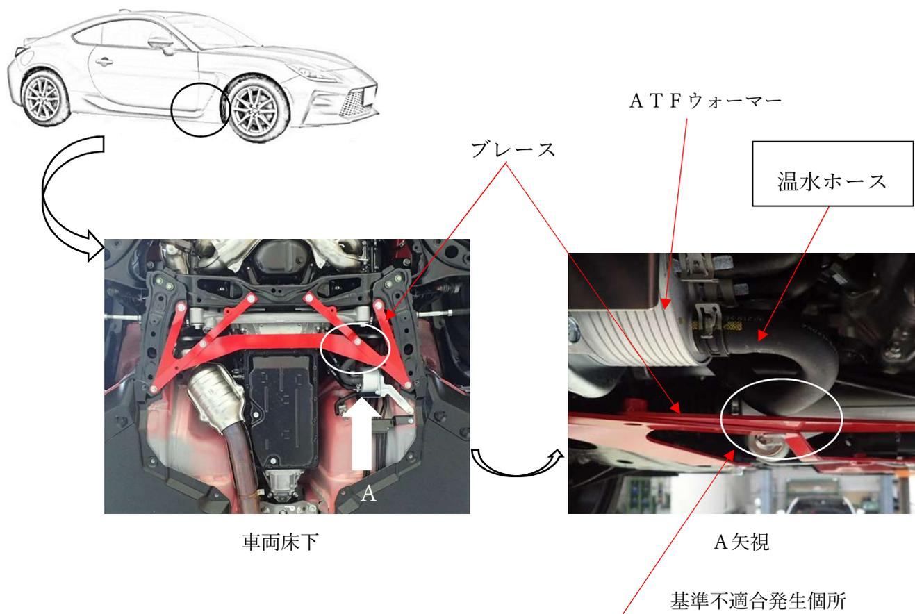
トヨタGR86の自動変速機仕様車に後付け部品ブレースを取り付けた場合において、ATFウォーマーの温水ホースに干渉する可能性がある。そのため、最悪の場合、温水ホースが破損し、オーバーヒートとなり走行できなくなる可能性がある。
